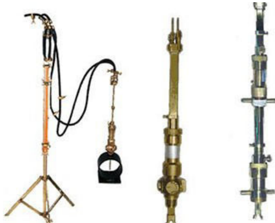
Figura 186 - Tubo Pitot tipo Cole.
